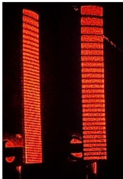
Abbildung 16: zur Ermittlung der Biegepeile (links: 47 Streifen; rechts: 24 Streifen)
