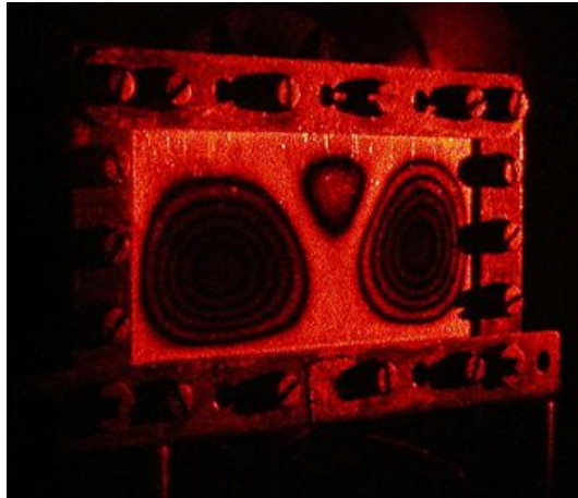
Abbildung 17: Rekonstruktion der angeregten Schwinung einer Aluminiumplatte. Dieses Bild wurde im Zeitmittelverfahren aufgenommen.
